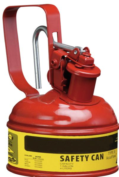
Maße: ca. 120 x 180 (D x H in mm) innen zinnbeschichtet, außen pulverbeschichtet - rot, selbstschließende Öffnung, Edelstahl-Flammsperre im Behälterhals, automatischer Überdruckausgleich, Behälterkennzeichnung nach GefStoffV und BGV A8.
