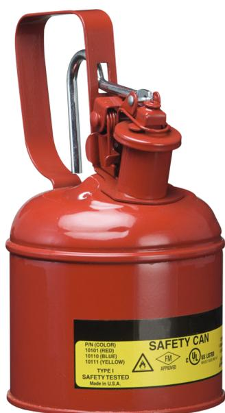
Maße: ca. 120 x 220 (D x H in mm) innen zinnbeschichtet, außen pulverbeschichtet - rot, Deckel selbstschließend, inkl. Edelstahl-Flammsperre im Behälterhals, automatischer Überdruckausgleich, Behälterkennzeichnung nach GefStoffV und BGV A8.
