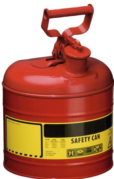
Maße: ca. 241 x 349 (D x H in mm) innen zinnbeschichtet, außen pulverbeschichtet - rot, Deckel selbstschließend, inkl. Edelstahl-Flammsperre im Behälterhals, automatischer Überdruckausgleich, Behälterkennzeichnung nach GefStoffV und BGV A8. Prüfungen: FM, UL, TÜV-GS
