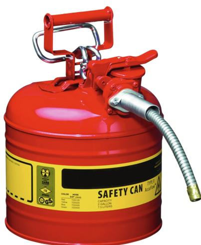
Stahlblech, innen zinnbeschichtet, außen pulverbeschichtet - rot, Deckel selbstschließend, Edelstahl-Flammsperre in Behälteröffnung, automatischer Überdruck-/Vakuumausgleich, Maße: ca. 241 x 337 (D x H in mm), verzinkter Metallschlauch, Länge: ca. 229 mm, Schlauchdurchmesser: ca. 16 mm, Behälterkennzeichnung nach GefStoffV und BGV A8. Prüfungen: FM, UL, TÜV-GS
