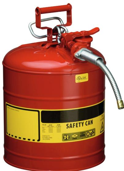
Stahlblech, innen zinnbeschichtet, außen pulverbeschichtet - rot, Deckel selbstschließend, Edelstahl-Flammsperre in Behälteröffnung, automatischer Überdruck-/Vakuumausgleich, Maße: ca. 298 x 445 (D x H in mm), verzinkter Metallschlauch, Länge: ca. 229 mm, Schlauchdurchmesser: ca. 16 mm, Behälterkennzeichnung nach GefStoffV und BGV A8. Prüfungen: FM, UL, TÜV-GS
