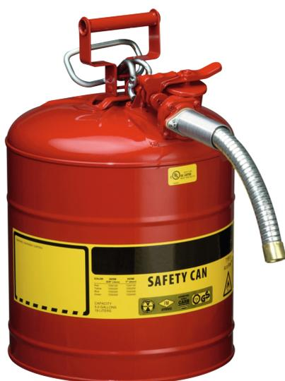
Stahlblech, innen zinnbeschichtet, außen pulverbeschichtet - rot, Deckel selbstschließend, Edelstahl-Flammsperre in Behälteröffnung, automatischer Überdruck-/Vakuumausgleich, Maße: ca. 298 x 445 (D x H in mm), verzinkter Metallschlauch, Länge: ca. 229 mm, Schlauchdurchmesser: ca. 25 mm, Behälterkennzeichnung nach GefStoffV und BGV A8. Prüfungen: FM, UL, TÜV-GS
