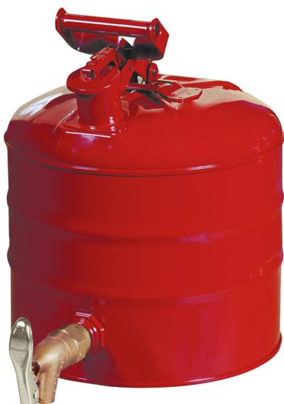
Stahlblech, innen zinnbeschichtet, außen pulverbeschichtet - rot, Zapfhahn aus Messing, Einfüllöffnung und Zapfhahn selbstschließend, Flamm Sperre in Behälteröffnung und Zapfhahn, automatischer Überdruck-/Vakuumausgleich, Maße: ca. 298 x 292 (D x H in mm), Behälterkennzeichnung nach GefStoffV und BGV A8. Prüfungen: FM-GEPRÜFT
