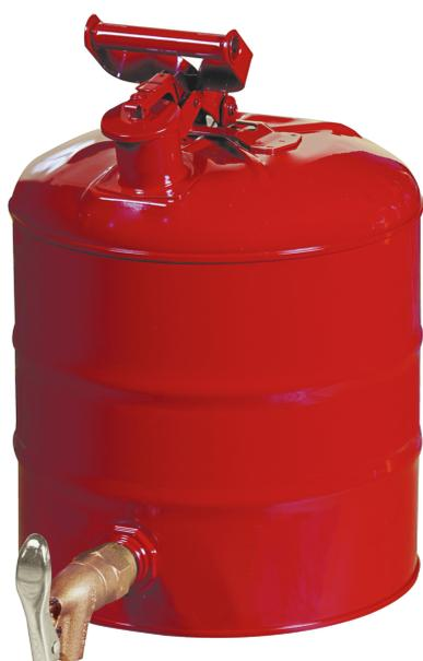
Stahlblech, innen zinnbeschichtet, außen pulverbeschichtet - rot, Zapfhahn aus Messing, Einfüllöffnung und Zapfhahn selbstschließend, Flamm Sperre in Behälteröffnung und Zapfhahn, automatischer Überdruck-/Vakuumausgleich, Maße: ca. 295 x 410 (D x H in mm), Behälterkennzeichnung nach GefStoffV und BGV A8. Prüfungen: FM-GEPRÜFT
