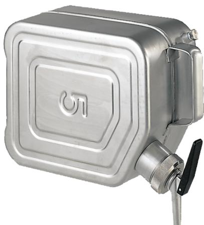
Edelstahl 1.4571 poliert Maße: ca. 130 x 280 x 210 (B x T x H in mm) Flamm Sperre im Behälterhals, incl. selbstschließender Abfüllhahn, manueller Überdruck-/Vakuumausgleich, Behälterkennzeichnung nach GefStoffV und BGV A8.
