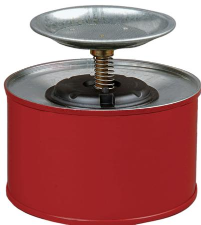
Maße: ca. 180 x 145 (D x H in mm) Tränkeller-Durchmesser: ca. 135 mm innen zinnbeschichtet, außen pulverbeschichtet rot, Tränkeller mit Flamm Sperre, Pumpwerk aus Messing und PPS, Behälterkennzeichnung nach GefStoffV und BGV A8. Prüfungen: FM-geprüft
