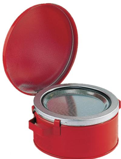
Maße: ca. 240 x 120 (D x H in mm) innen zinnbeschichtet, außen pulverbeschichtet rot, Flamm Sperre als Tränkteller, Behälterkennzeichnung nach GefStoffV und BGV A8. Prüfungen: FM-geprüft
