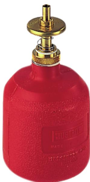
Maße: ca. 80 x 145 (D x H in mm) Behälter aus HDPE (bruchsicher), Verschlusskappe aus Messing (selbstschließend), Behälterkennzeichnung nach GefStoffV und BGV A8. Prüfung: FM-geprüft
