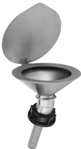
Einfüllöffnung 180 mm Durchmesser, mit Überwurfverschraubung aus Kunststoff, Überfüllsicherung, Klappdeckel, Alveocel-Dichtung, Flamm Sperre Edelstahl (austauschbar), mit Flansch 2 Erdungstifte, 2 Griffflaschen, Anschluss für Erdungskabel unterhalb des Deckelscharniers, in Verbindung mit Kanister wird ein Überfüllen verhindert, Kennzeichnung nach GefStoffV und BGV A8.
