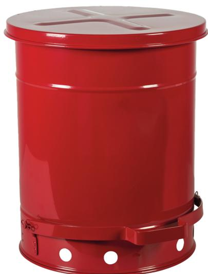
Maße: ca. 354 x 464 (D x H mm), Stahlblech, außen pulverbeschichtet rot, innen zinnbeschichtet, selbstschließender Deckel, wird über Fußpedal geöffnet, Behälterkennzeichnung nach GefStoffV und BGV A8. Prüfungen: FM/UL-geprüft
