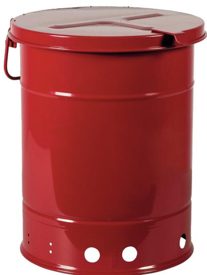
Maße: ca. 290 x 397 (D x H mm), Stahlblech, außen pulverbeschichtet rot, innen zinnbeschichtet, selbstschließender Deckel, Öffnung per Hand, Behälterkennzeichnung nach GefStoffV und BGV A8. Prüfungen: GS-ZEICHEN, FM/UL-GEPRÜFT
